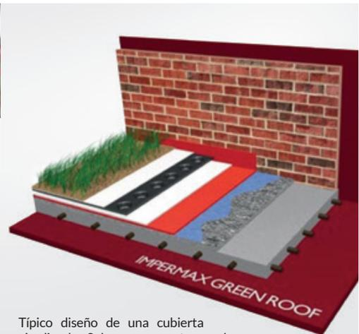
Típico diseño de una cubierta ajardinada. Sobre un soporte regularizado e imprimado se aplica la membrana impermeabilizante de Impermax 2K que se protege con un geotextil. Sobre ella se coloca una lámina drenante y de retención de humedad. El sistema termina con un sustrato y las plantas.
