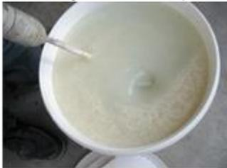
Se trata de una resina en base agua, de 2 componentes, que una vez mezclados son totalmente compatibles con soportes húmedos o mojados, y que tras su polimerización forman un producto cristalino de gran dureza y adherencia, que actúa como barrera frente a las humedades residuales y evita la formación de burbujas en la superficie.
